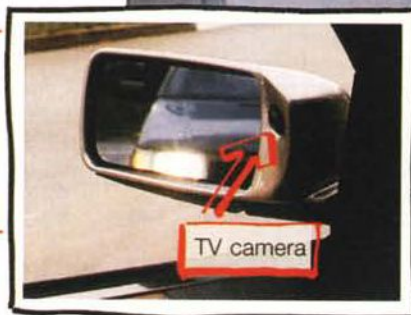
Fig. 9: Ecco il sensore di sorpasso a lavoro. Una telecamera alloggiata nello specchietto retrovisore allerta il guidatore della eventuale presenza di veicoli in fase di sorpasso. Il dispositivo è stato denominato FIAT Envis.
